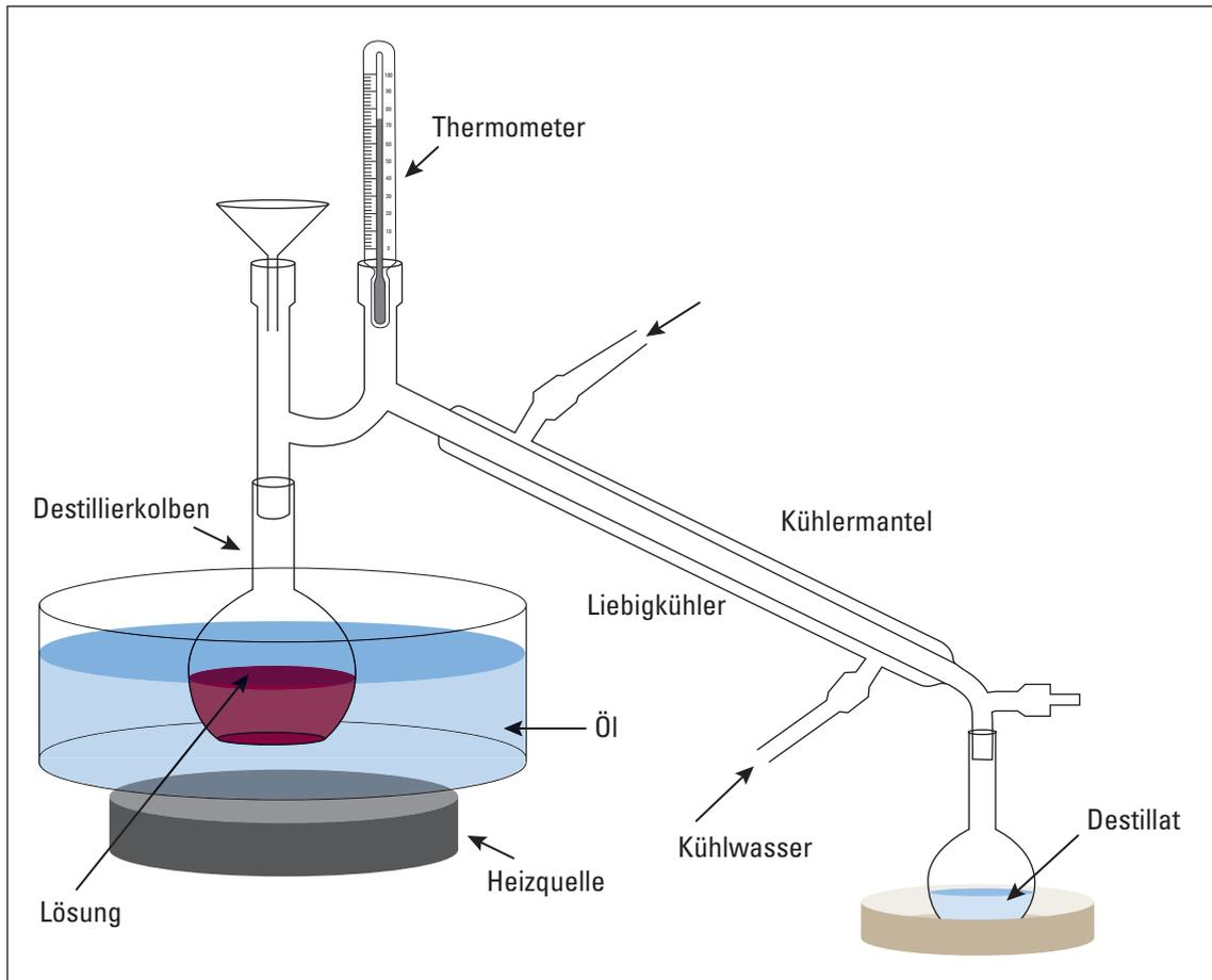
**Warnhinweise:** Während dieses Experimentes arbeiten Sie mit heißen Flüssigkeiten. Achten Sie auf ausreichende Standfestigkeit der Apparatur und sichern Sie die Verbindungsstücke mit Klemmen. Dringend muss auf ausreichende Schutzkleidung und -brille sowie Verwendung der Schutzscheibe geachtet werden.
